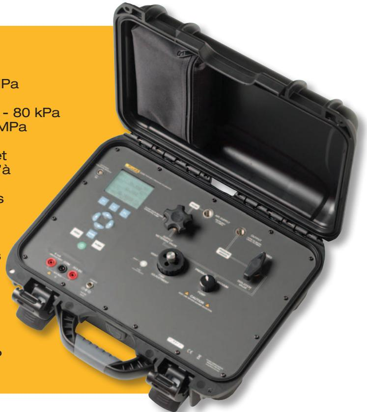
Le calibrateur de pression pneumatique portable 3130 est idéal pour étalonner les capteurs, les transmetteurs, les jauges de pression, ainsi que les appareils similaires. Le dispositif 3130 contient tout le nécessaire pour générer, contrôler et mesurer la pression, ainsi que pour lire la sortie de l'appareil testé.
